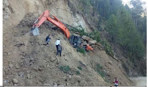
चित्र-18: चम्पावत-टनकपुर राष्ट्रीय राजमार्ग में भूस्खलन से क्षतिग्रस्त पोकलैंड मशीन (स्रोत: हिन्दुस्तान)
