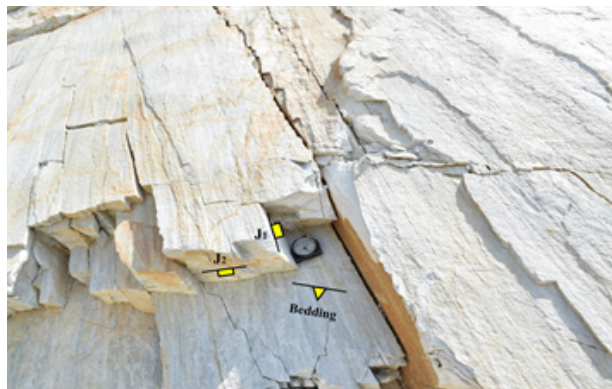
चित्र-8: भूस्खलन क्षेत्र में स्थान (क) पर क्वार्ट्जाइट शैल संस्तर तल पर स्थित संधि एवं दरारें
